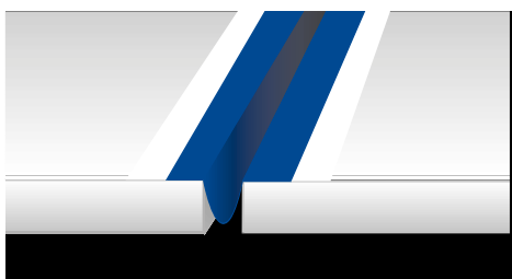
Mapeband omega formában elhelyezése mozgási hézagban
